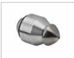
Насадка Warthog WV (50- 100 мм) 206 Бар @ 30 л/ мин - 9,5 мм
