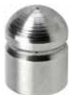
72705100 Закрытая насадка для 14-мм шланга 6 мм шланг, 19 л/мин, 206 Бар 727
