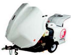
Звукоизолированная крышка двигателя с вертикальной осью для "газовой" пружины для легкого доступа к двигателю и технического обслуживания насоса
