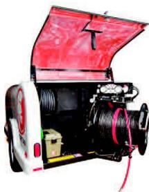
Все рычаги управления выдвигаются вместе с патентованной поворачивающейся на 180 градусов катушкой шланга, когда задняя крышка машины поднята
