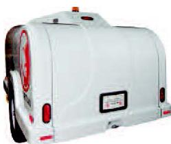
Задняя часть каналопромывочной машины полностью герметизирована и закрыта для безопасной транспортировки и хранения
