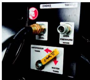
Soldier идет в комплекте с одноклапанной полносистемной антифризовой защитой для работ в холодную погоду
