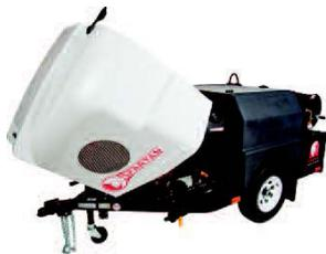
Кожух двигателя устанавливается вертикально на топливные стойки для легкого доступа к двигателю и технического обслуживания насоса
