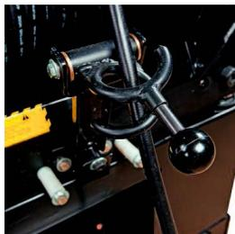
Направляющая шланга при перемотке движется вместе с катушкой и позволяет оператору вставить шланг перед началом новой перемотки
