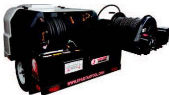
Поворачивающаяся катушка шланга с регулируемой электроперемоткой шланга позволяет обеспечить максимально легкий доступ к трубе для оптимальной прочистки
