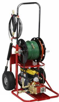
Машина Spartan 717 включает ручной пистолет, устройство для очистки с разнообразными насадками, очиститель устья насадок, рукавицы безопасности, 3 шланга и 8 насадок, как описано справа
