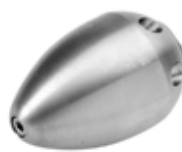
73700100 Ракетообразная насадка 13 мм шланг, 45 л/мин, 206 Бар 738/758/Soldier
